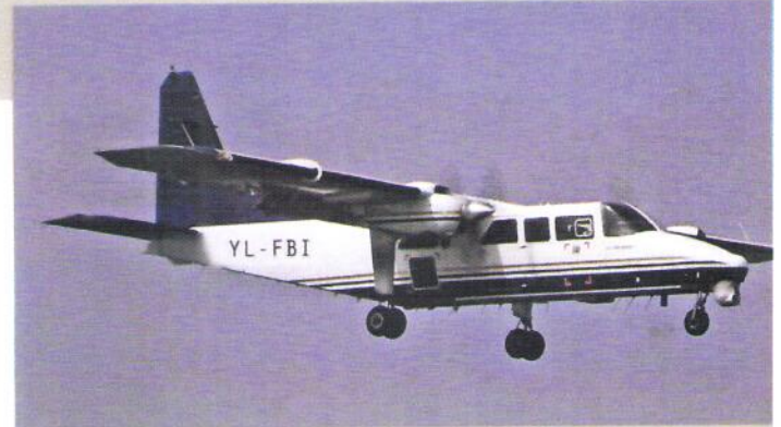
VRI attālās izpētes platforma. Speciāli aviācijas darbiem paredzēta divmotoru lidmašīna BN-2T-4S Defender.
